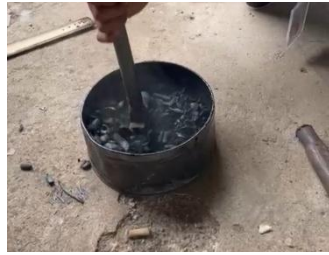
Gambar 4. Proses penumbukan arang dari biji karet
