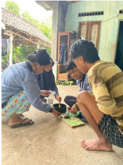
Gambar 7. Dokumentasi pencampuran dan perekatan arang, air hangat, dan tepung tapioka
