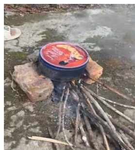
Gambar 3. Proses pembakaran / pirolisis cangkang kulit biji karet
